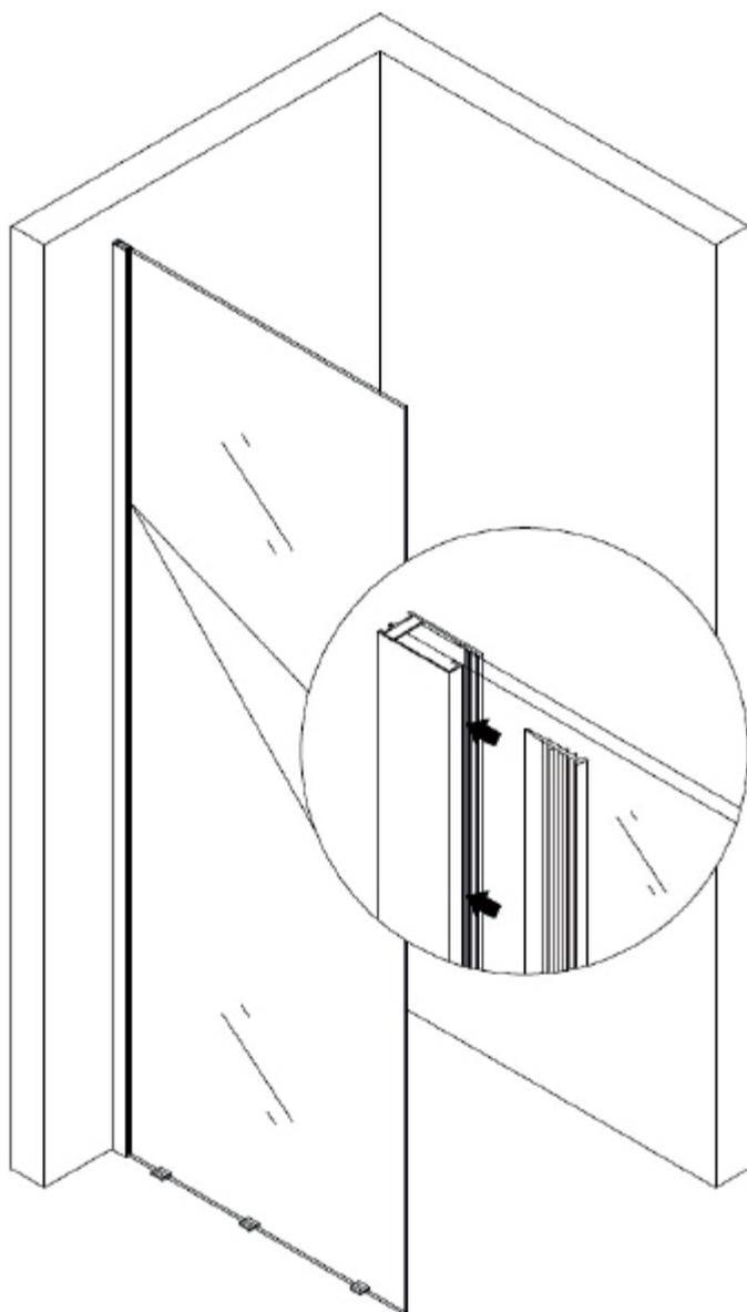
1. Montieren Sie die Stange und markieren Sie das Bohrloch. bohren Sie das Loch und spritzen danach Silikon ins Loch, nun schieben Sie das Dübel ein. Fixieren Sie jetzt die Stange nach Wunsch von 65-120cm.
