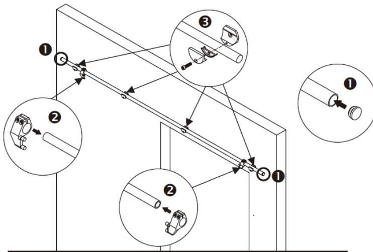
Bohren Sie die gekennzeichnete Löcher. Montieren Sie danach die Halter für die Laufschiene.
