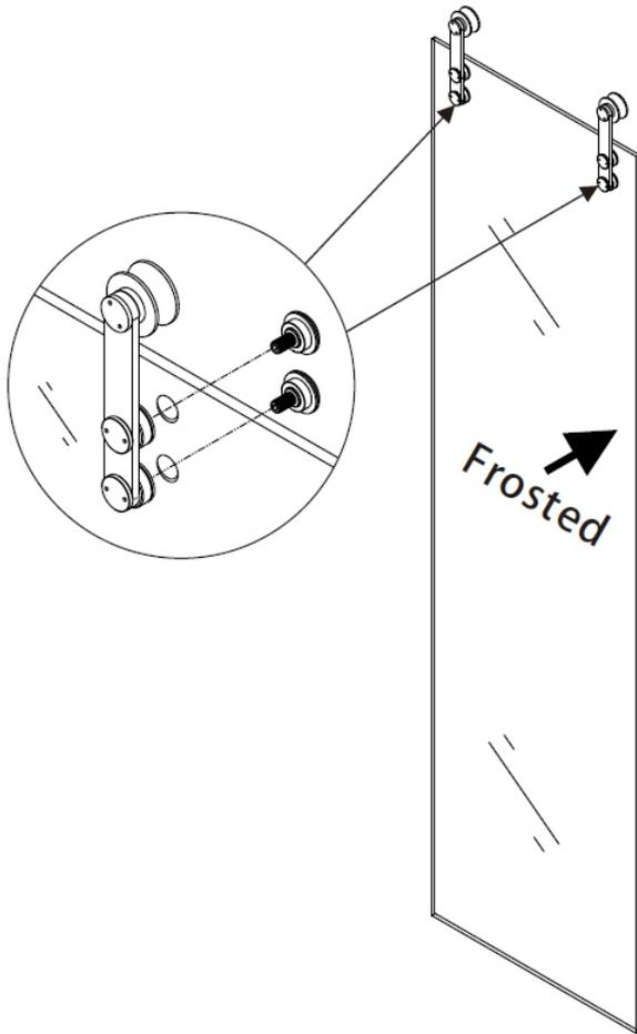
Montieren Sie die Türbeschläge.
